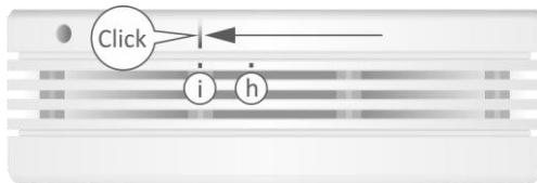
(op positie i)! Het apparaat wordt nu geactiveerd en telt af van 60 tot 0. Na ongeveer 60 seconden is het koolmonoxidemelder volledig opgestart. Controleer vervolgens of het apparaat goed werkt door de test/mute-knop ongeveer 3 seconden ingedrukt te houden. Als het apparaat naar behoren werkt, zal het viermaal piepen en rood knipperen. Als dit niet het geval is, gebruik het apparaat dan niet en neem contact op met de leverancier.
