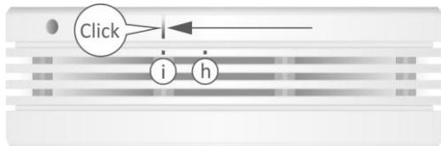
FÜHLEN (in Position i)! Das Gerät wird nun aktiviert und zählt von 60 auf 0 herunter. Nach etwa 60 Sekunden ist der Kohlenmonoxidalarm vollständig hochgefahren. Prüfen Sie nun, ob das Gerät ordnungsgemäß funktioniert, indem Sie die Test-/Stummschalttaste ca. 3 Sekunden lang gedrückt halten. Wenn das Gerät ordnungsgemäß funktioniert, piept es viermal und blinkt rot. Sollte dies nicht der Fall sein, verwenden Sie das Gerät nicht und wenden Sie sich an den Lieferanten.
